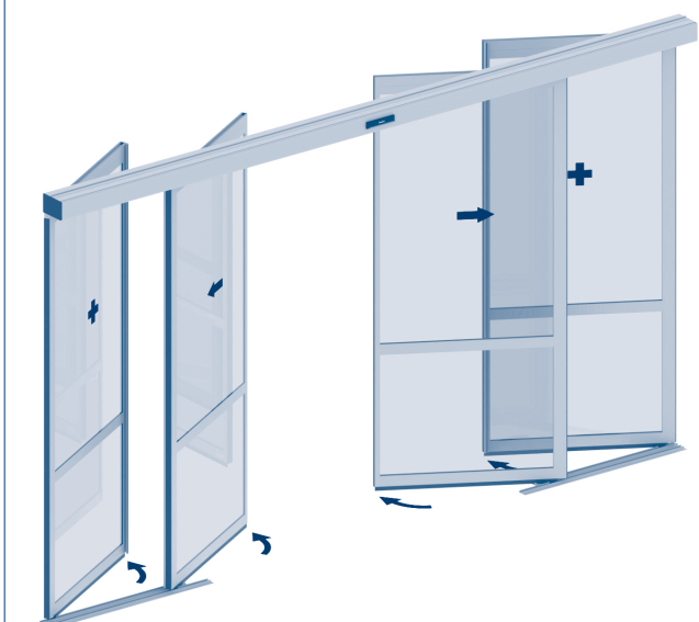
Рис. 8.1. Две подвижные (ПС) и две неподвижные створки (НС) «антипаника»
